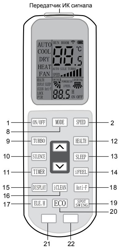
заданную температуру на 1 °С. Через 2 часа температура принимает новое значение, которое поддерживается постоянным в течении следующих 5 часов. После этого кондиционер отключается.
