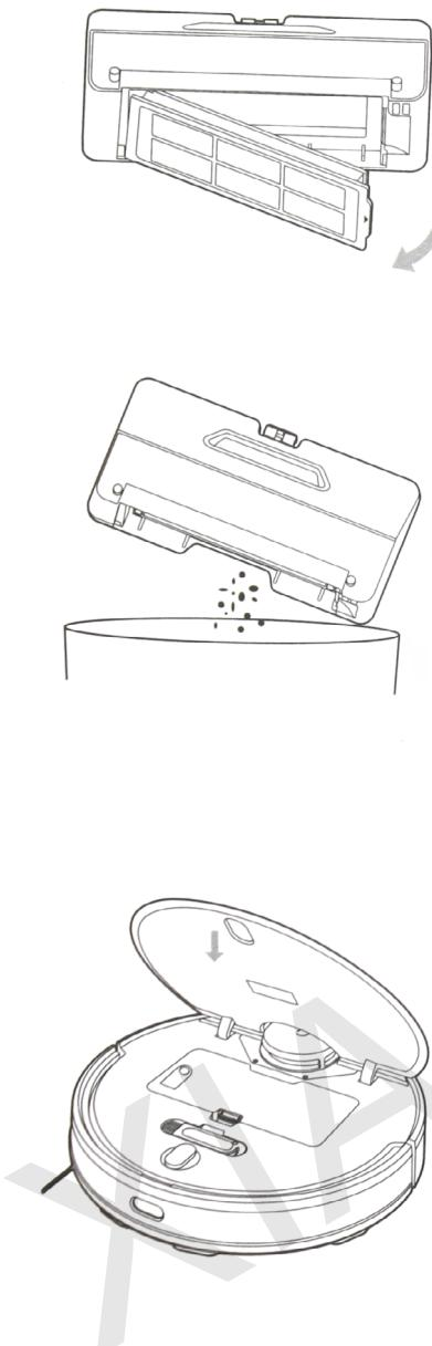
1. Извлеките резервуар из устройства. Откройте резервуар, отодвинув фильтр, как показано на рисунке.
