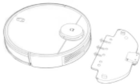
4. Нажмите и удерживайте боковые защелки монтажной пластины, затем вставьте пластину горизонтально в устройство, как показано на рисунке.
