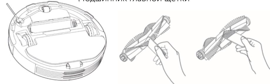
1. Переверните робот и нажмите на защелку, чтобы снять крышку основной щетки.
