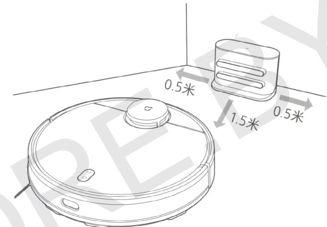
Примечание: Оставьте не менее чем 0.5 метра с боковых сторон, и 1.5 для въезда робота-пылесоса. Зафиксируйте кабель зарядки, чтобы он не провисал и не отсоединялся. Индикатор зарядки оповестит о начале зарядки, после отключится.
