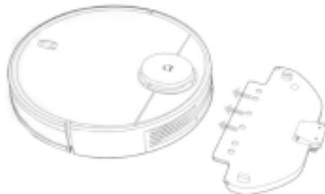
4. Нажмите и удерживайте боковые защелки монтажной пластины, затем вставьте пластины горизонтально в устройство, как показано на рисунке.
