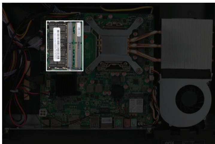
2) Чтобы установить модуль памяти, совместите вырез (1) на новом модуле памяти с выступом в гнезде для модуля памяти. Вставьте модуль памяти в гнездо (2) под углом примерно 30°, затем нажмите на модуль памяти (3) так, чтобы фиксаторы встали на место.
