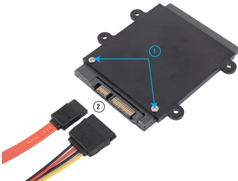
Подключаем кабели SATA к разъёмам на плате
