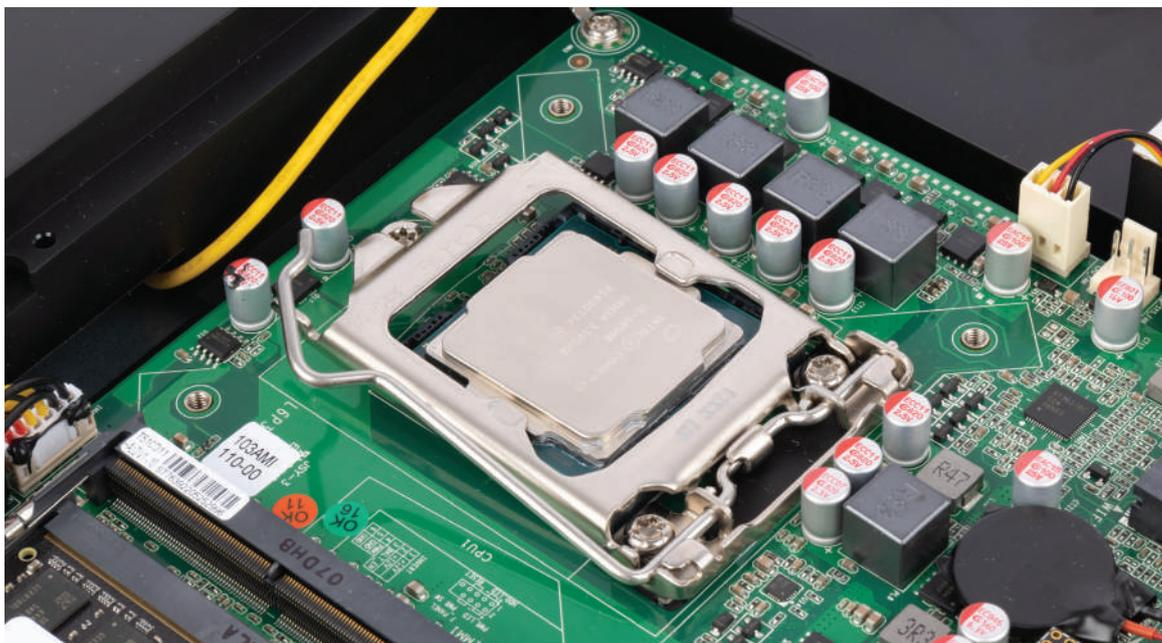
Наносимо термопасту, встановлюємо на місце систему охолодження.
