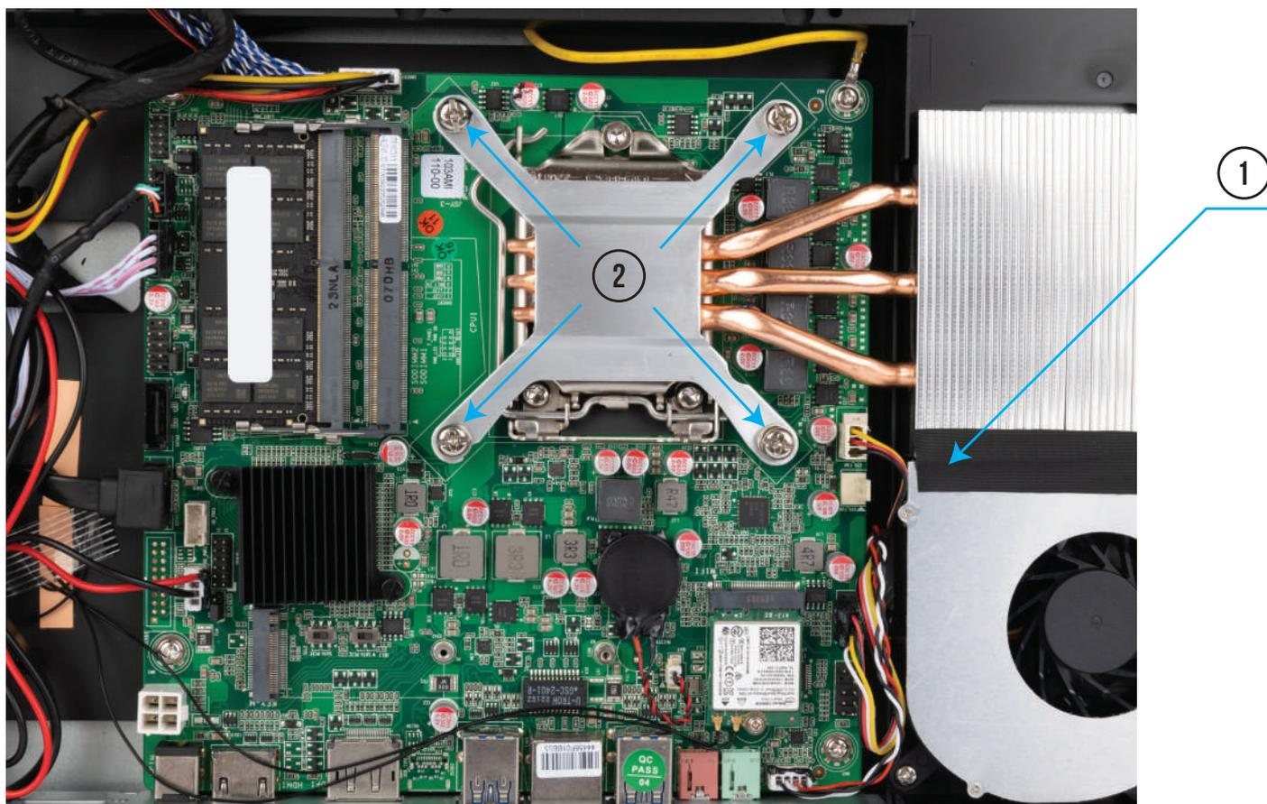
Отгибаем держатель рамки процессора в стороны и поднимаем вверх
