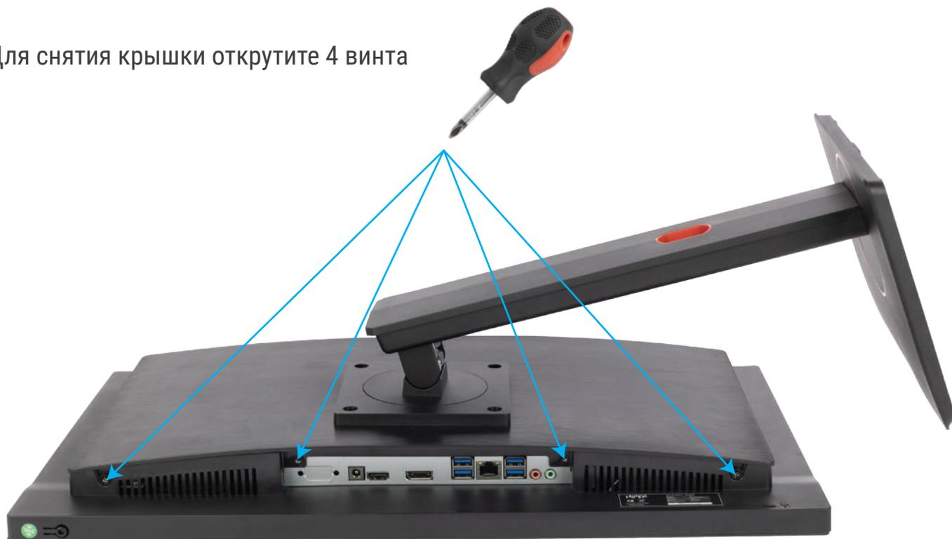
Затем сдвиньте крышку на себя (1) и поднимите её вверх (2)
