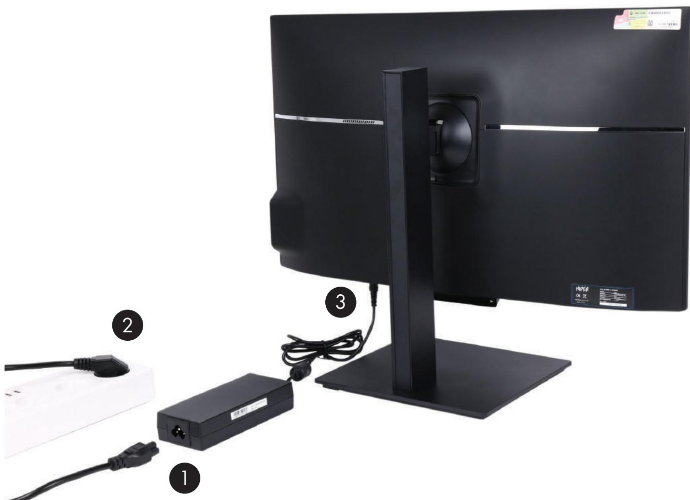
Подсоедините один конец кабеля питания к адаптеру переменного тока (1), а другой конец – к заземлённой электрической розетке (2), затем подсоедините адаптер переменного тока к разъёму питания компьютера (3).
