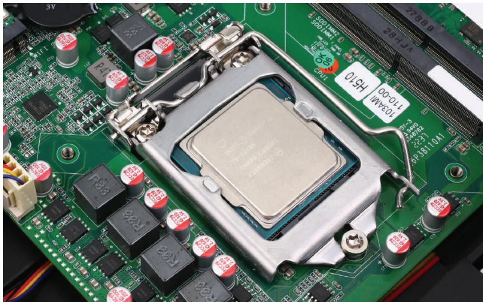
Нанесите термопасту и установите на место систему охлаждения.
