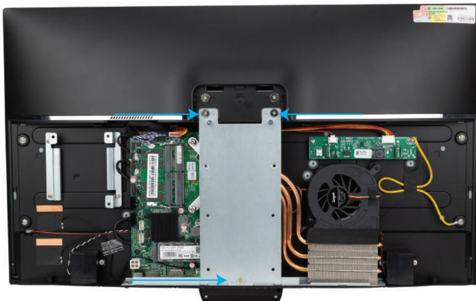
Закройте крышку, задвиньте ее и закрутите винтами (1) и (2).
