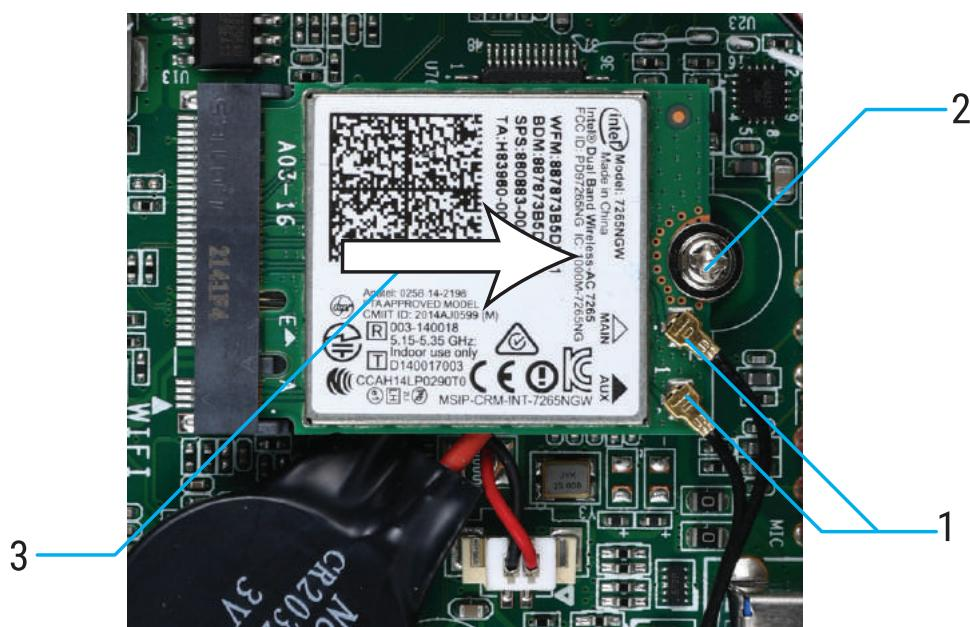
Вставьте до упора новый модуль беспроводной сети в гнездо (1) на системной плате, а затем зафиксируйте его с помощью прилагаемого винта (2). Затем подсоедините антенные кабели (3) к разъемам на модуле.
