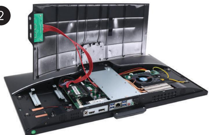
Открутите 3 винта для снятия защитного экрана.
