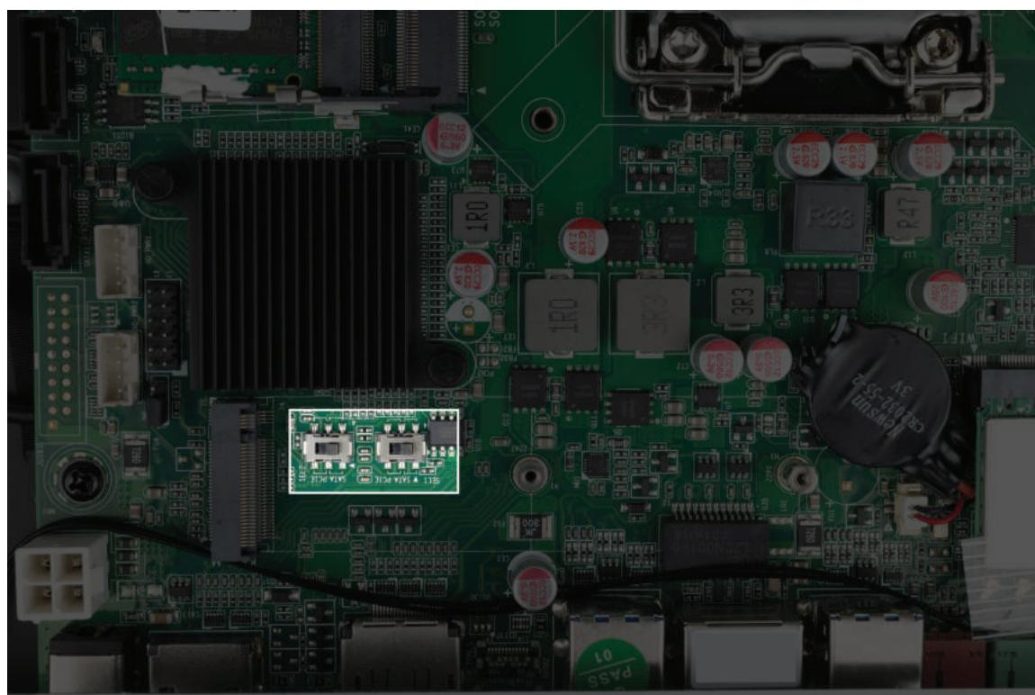
3) Вставьте разъём нового твердотельного накопителя в гнездо (1) на системной плате под углом примерно 30° и закрепите его с помощью винта (2).
