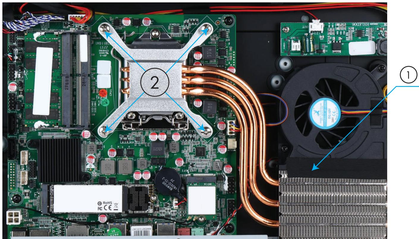
Отоните держатель рамки процессора в стороны и поднимите его вверх.
