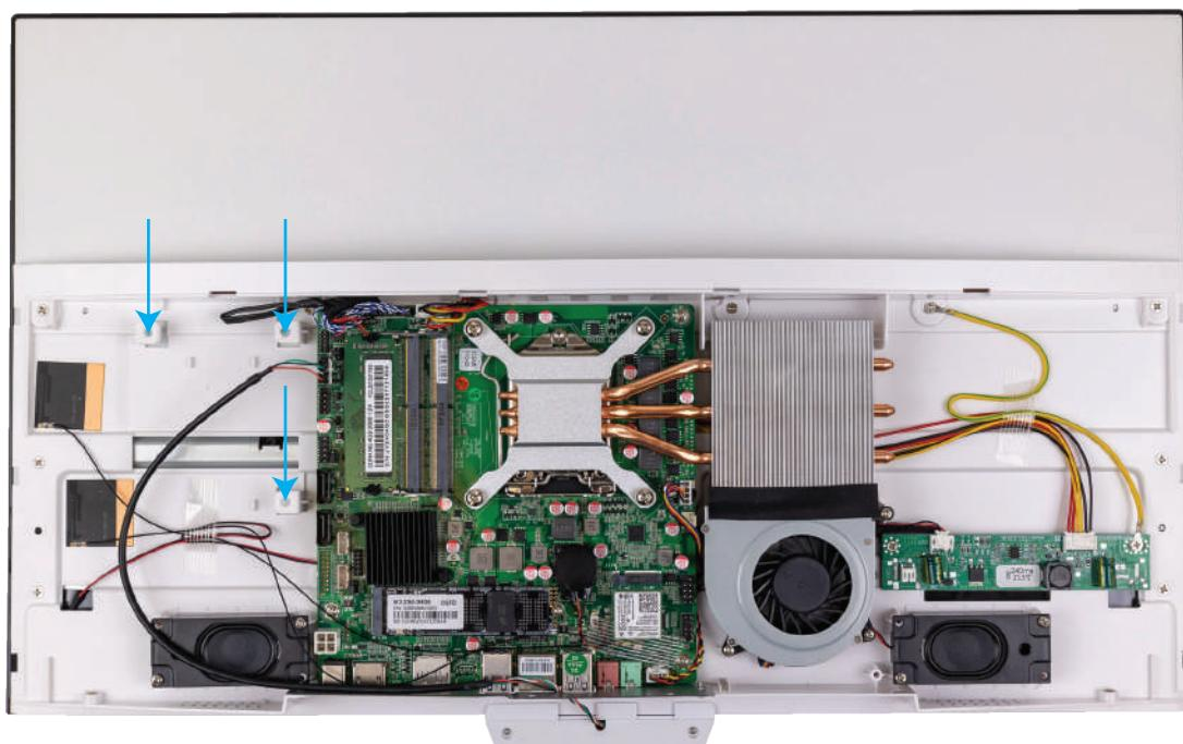
Подключаем кабели SATA в соответствующие разъёмы на системной плате
