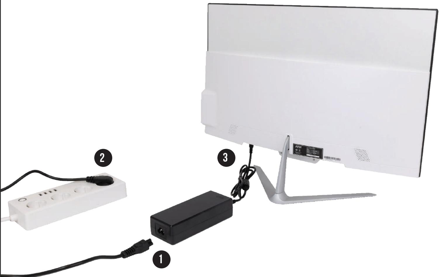
Подсоедините один конец кабеля питания к адаптеру переменного тока (1), а другой конец – к заземлённой электрической розетке (2), затем подсоедините адаптер переменного тока к разъёму питания компьютера (3).
