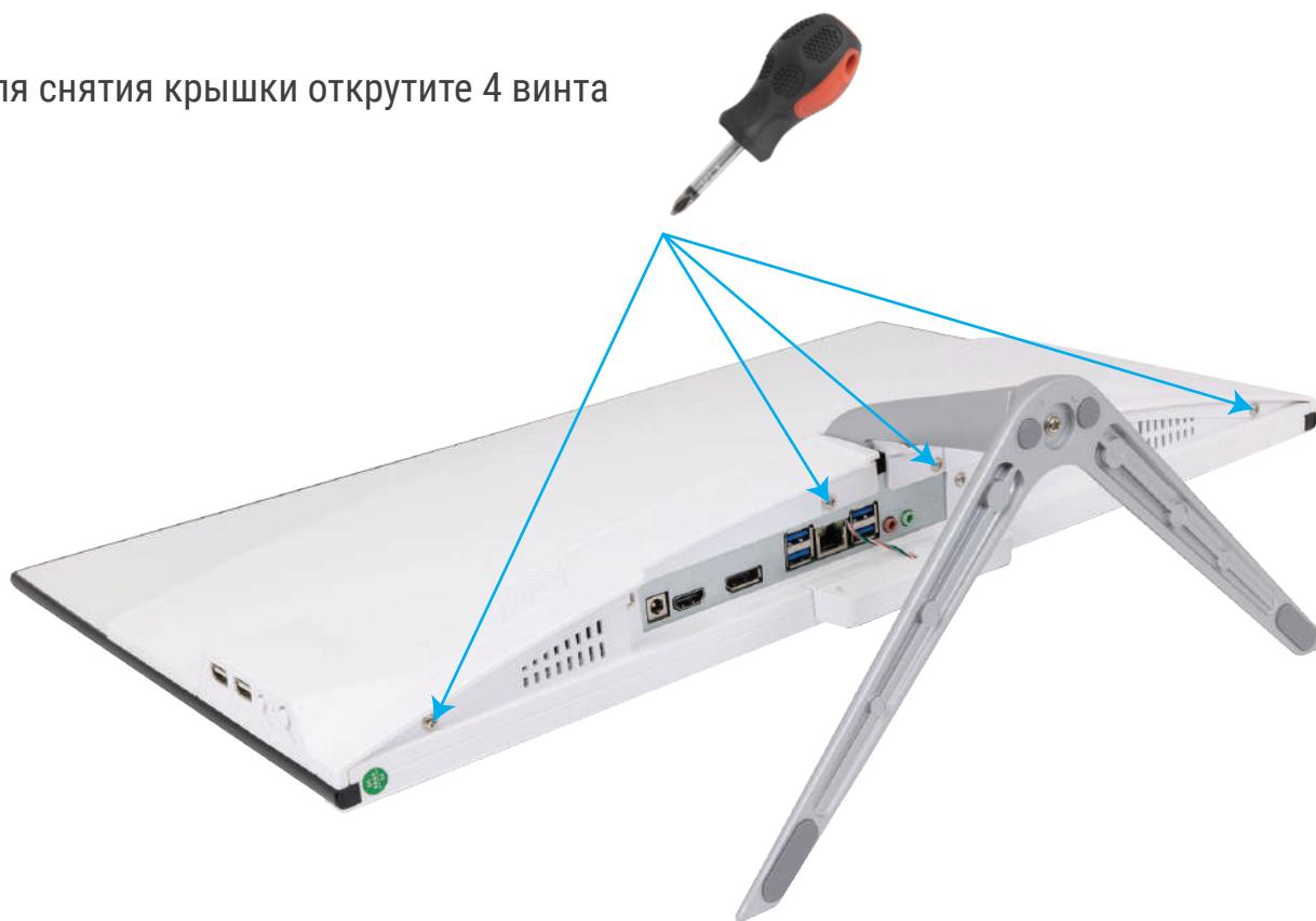
Затем сдвиньте крышку на себя (1) и поднимите её вверх (2)
