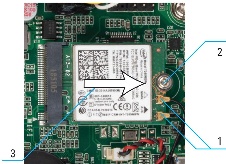
Вставьте до упора новый модуль беспроводной сети в гнездо (1) на системной плате, а затем зафиксируйте его с помощью прилагаемого винта (2). Затем подсоедините антенные кабели (3) к разъемам на модуле.
