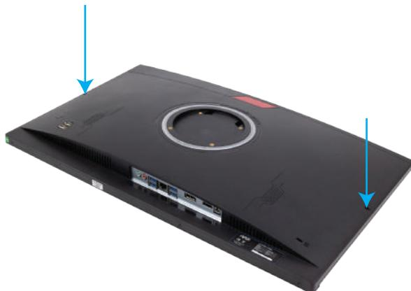
2. Переверните монитор и открутите 4 винта нижней панели (один из винтов находится под защитной наклейкой)
