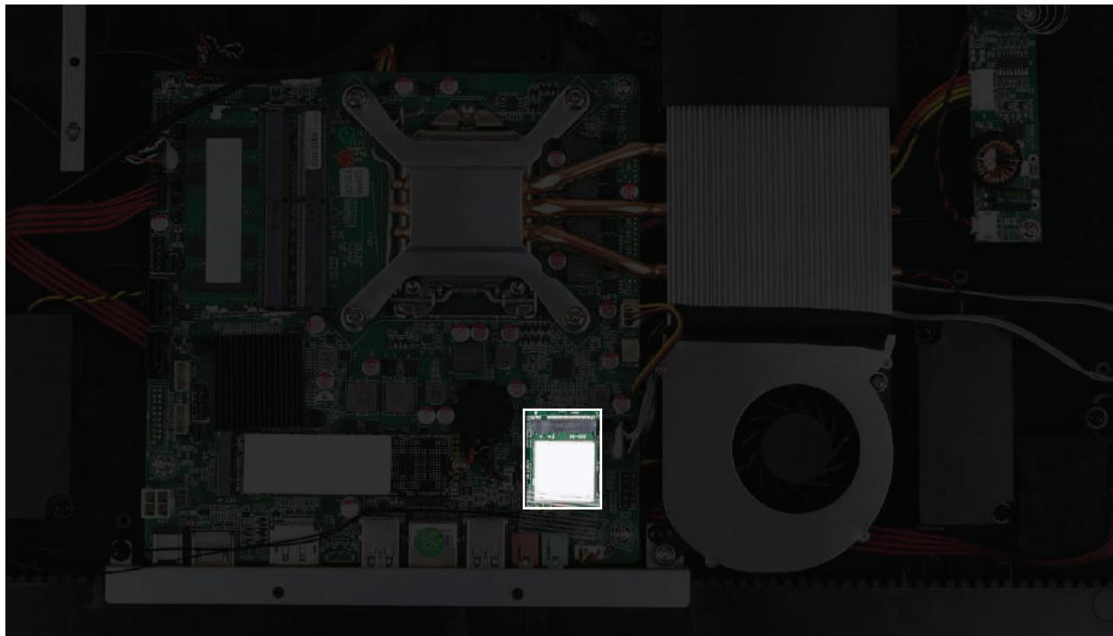
Отсоедините антенные кабели (1) от модуля беспроводной сети. Выверните винт (2), крепящий модуль беспроводной сети к системной плате, а затем возьмите модуль за боковые стороны и извлеките из гнезда (3).
