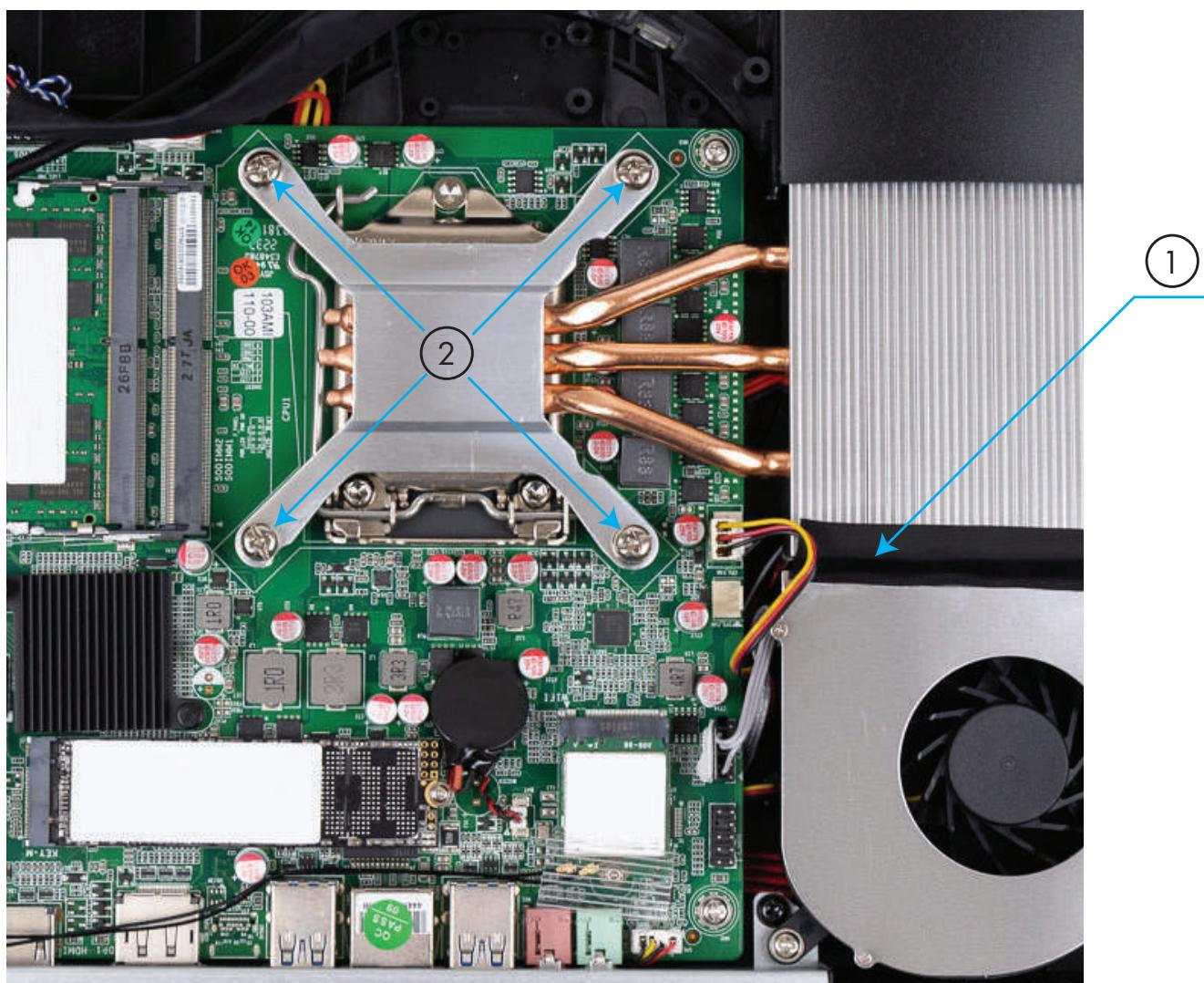
Отогните держатель рамки процессора в стороны и поднимите вверх
