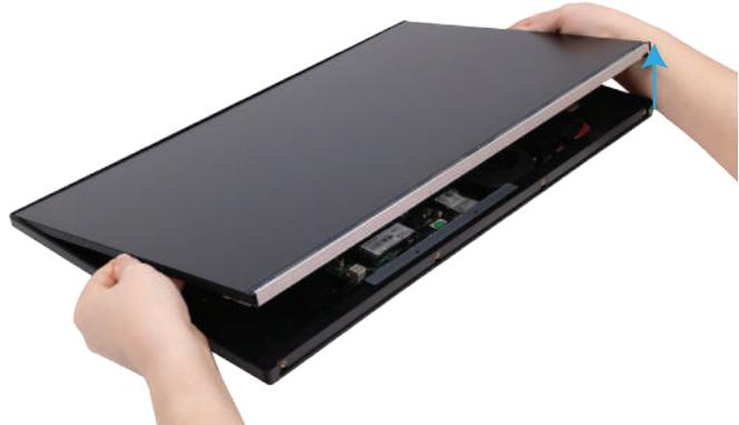
5. Поднимите задний край, аккуратно сдвиньте экран и положите его на край корпуса
