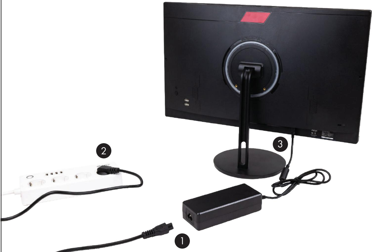
Подсоедините один конец кабеля питания к адаптеру переменного тока (1), а другой конец – к заземлённой электрической розетке (2), затем подсоедините адаптер переменного тока к разъёму питания компьютера (3).
