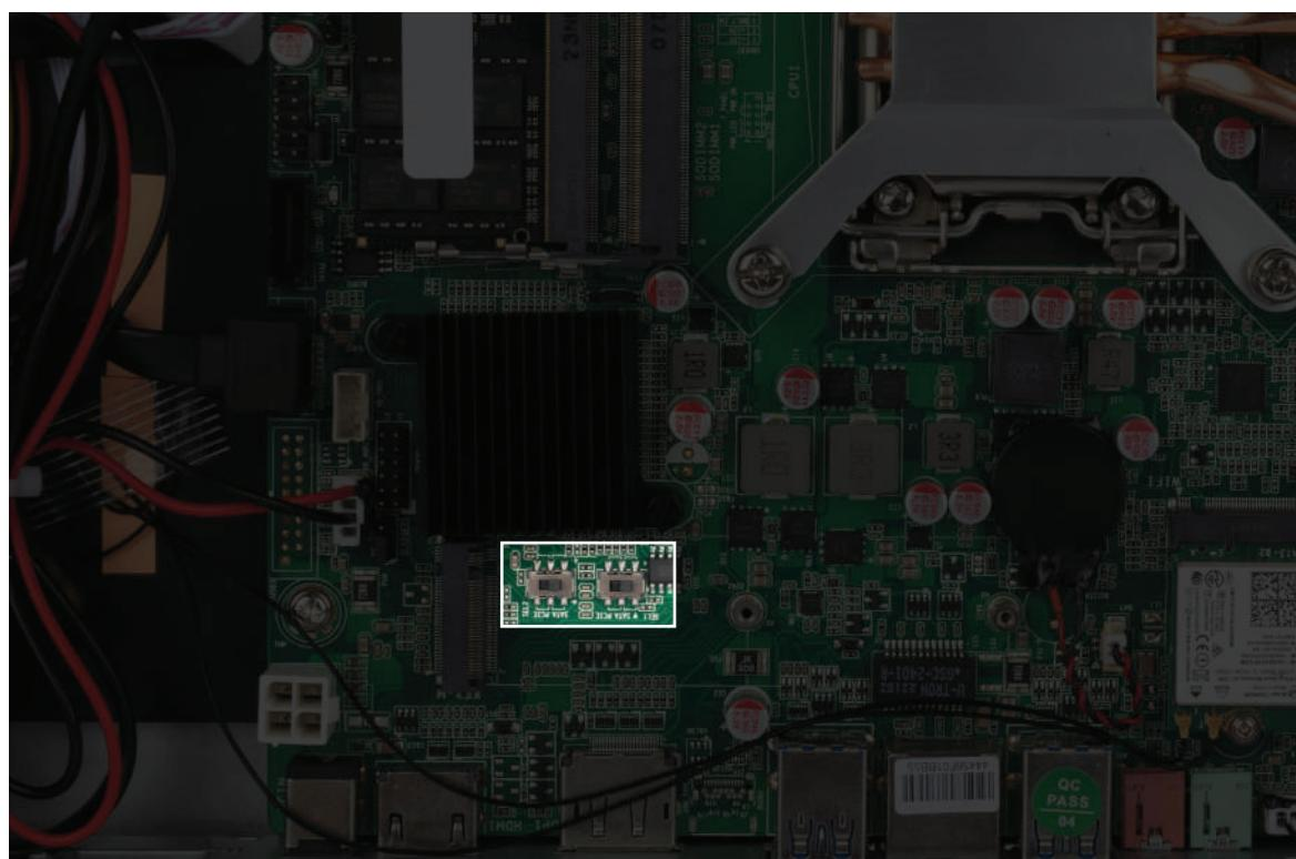
3) Вставьте разъём нового твердотельного накопителя в гнездо (1) на системной плате под углом примерно  $30^{\circ}$  и закрепите его с помощью винта (2).
