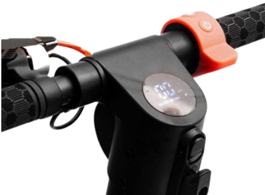
НИЖНЯЯ кнопка (Source) на оранжевом курке акселератора отвечает за ВКЛЮЧЕНИЕ/ОТКЛЮЧЕНИЕ самоката.
