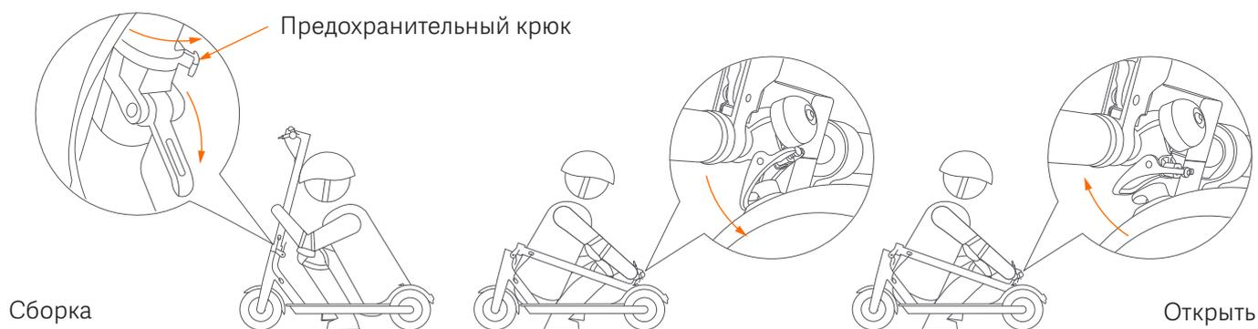
Перед сборкой самокат необходимо отключить. Удерживая рулевую стойку, поверните ее против часовой стрелки, чтобы открыть предохранительный крюк, и опустите рычаг фиксатора.
