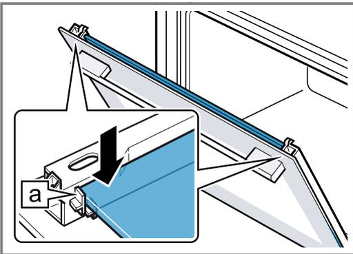
5. Die Gerätetür öffnen und Türdichtung einhängen.
