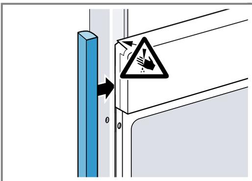
2. Aluprofile vorbohren, um eine Schraubverbindung herzustellen.
