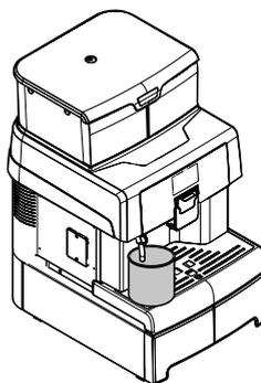
Подтвердите нажатием кнопки «OK». Машина выполнит нагрев системы. По достижении нужной температуры машина начинает подачу пара. Для прекращения подачи пара нажмите кнопку «Экстра» или кнопку «ESC». Если необходимо, по окончании использования очистите трубку подачи пара влажной тряпкой.
