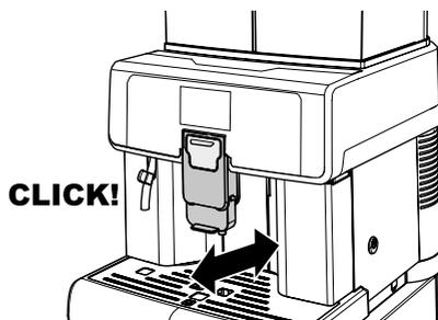
Перед включением машины следует убедиться, что вилка правильно вставлена в электрическую розетку. Для включения машины переведите главный выключатель, расположенный на задней стороне машины, в положение «I».
