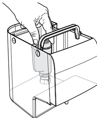
Наполните бак свежей питьевой водой и вставьте его обратно в машину.
