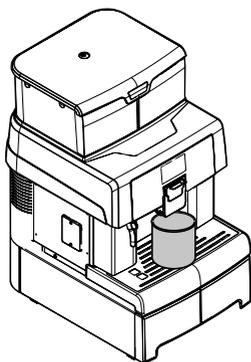
Нажмите кнопку «Coffee», чтобы начать подачу. Машина выполнит подачу кофе из устройства подачи; дождитесь завершения подачи и опорожните емкость. Повторите такие подачи 3 раза.
