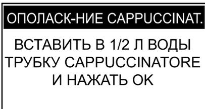
Хорошо вымойте емкость, использованную для раствора, и наполните ее 1/2 (половиной) литра свежей питьевой воды, которая будет использована для ополаскивания. Опорожните емкость, установленную под устройством подачи. Вставьте трубку подачи в используемую емкость. Нажмите кнопку «ОК» для подтверждения.
