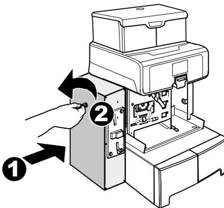
Установите на место и закрепите передний кожух с предварительно снятым винтом. Установите на место устройство подачи кофе. Установите на место поддон для сбора капель.
