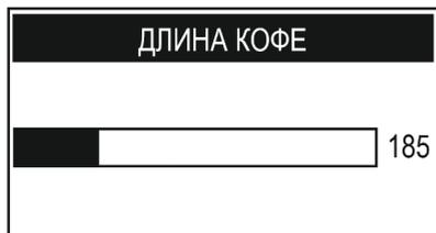
Нажимайте кнопку «DOWN» или кнопку «UP» для выбора нужного значения, перемещая полосу; расположенное сбоку число указывает значение (в импульсах) в отношении полосы. После этого нажмите кнопку «ОК» для подтверждения и выхода.
