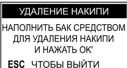
Наполните бак водой с раствором для удаления накипи до уровня CALC CLEAN, указанного на задней стороне бака.
