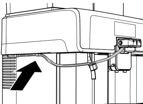
В случае наличия монетоприемника поместите трубку, как показано на рисунке, используя ранее снятую крышку.
