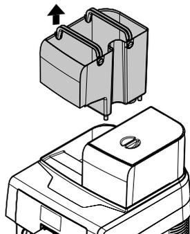
Ополосните и наполните бак свежей водой; не превышайте максимальный уровень (MAX), указанный на баке.
