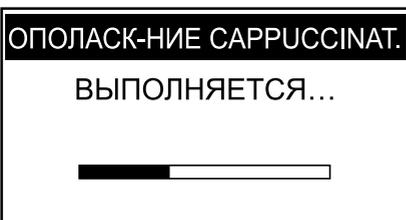
Машина произведет цикл ополаскивания Carpuccinatore. Полоска шкального индикатора показывает прогресс ополаскивания.
