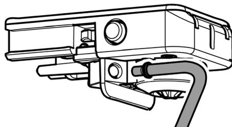
В таком случае всасывающую трубку можно вставить в крепления, как показано на рисунке.
