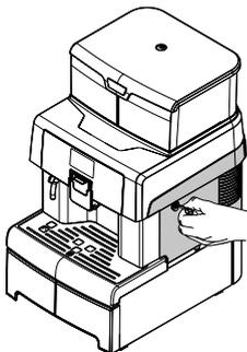
Достаньте блок приготовления кофе, для этого потяните за специальную ручку и нажмите кнопку «PRESS». Блок приготовления кофе можно мыть только теплой водой без моющего средства.
