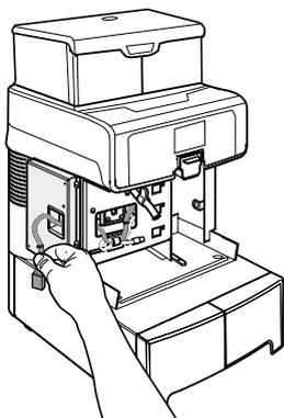
Закрепите ящик монетоприемника к проставке с помощью 2 винтов из комплекта поставки.
