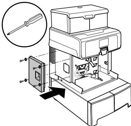
Машина оснащена двумя разными коннекторами, один для платежной системы «Аpollo», квадратной формы, и второй, прямоугольной формы, для присоединения монетоприемника.
