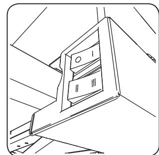
Работа вытяжки контролируется при помощи совмещенного переключателя.
