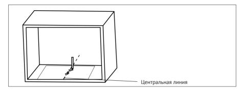
3. Снимите шаблон с нижнего модуля и закрепите установочный кронштейн винтом.
