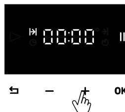
Сначала с помощью кнопок **- +** задайте значение минут, затем, нажав кнопку **OK** перейдите к настройке значения часов.
