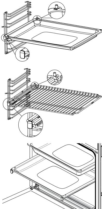
Schieben Sie die Schienen ganz nach innen, ohne das Tablett und das Drahtgitter darauf zu platzieren. Das Zubehör muss sich zwischen dem vorderen und hinteren Überstand der Schienen befinden.
