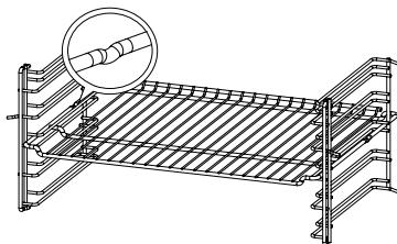
На проволочных направляющих имеются углубления, которые предотвращают падение с них противня или решетки и обеспечивают безопасное размещение.
