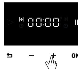
Wählen Sie zunächst die Minute mit den Tasten **- +** und aktivieren Sie die Uhr durch Drücken der **OK** Taste on.
