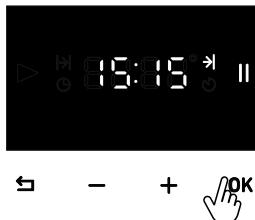
Um den Garvorgang abzuschließen, drücken Sie nach der Auswahl von Minute und Stunde die **OK**-Taste, bis der Garbildschirm erscheint.
