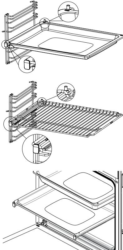
Задвинуть направляющие полностью внутрь, не устанавливая на них предварительно противень или проволочную решетку. Дополнительная принадлежность должна располагаться между передним и задним выступами направляющих.
