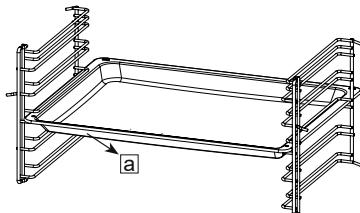
Дополнительную принадлежность (противень или решетку) следует вставлять между двумя направляющими, при этом наклонная сторона должна быть обращена к двери прибора.
