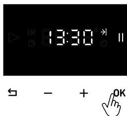
Um den Garvorgang abzuschließen, drücken Sie nach der Auswahl von Minute und Stunde die **OK** Taste, bis der Garbildschirm erscheint.
