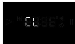
С помощью кнопок **-** + выведите на экран дисплея значение **CL** и затем подтвердите выбор нажатием кнопки **OK**.
