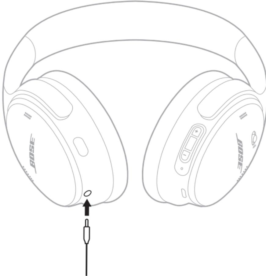
2. Подключите мини-штекер 3,5 мм к соответствующему выходу на устройстве.
