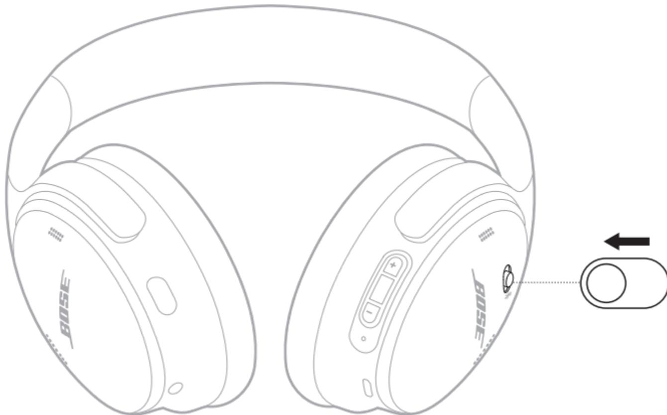
**Примечание:** при отключении наушников выключается и функция шумоподавления.
