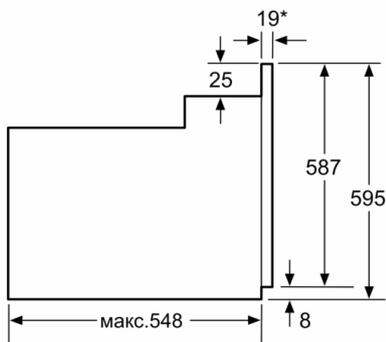
\* При металлической фронтальной панели 20 мм
