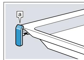
**Заметка:** В полностью выдвинутом положении направляющие фиксируются. Слегка нажмите на выдвигные направляющие при задвигании их обратно в рабочую камеру.
