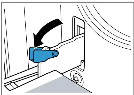
3. Закройте дверцу духового шкафа до упора. Возьмитесь за нее обеими руками слева и справа. Еще немного прикройте дверцу и вытащите ее.
