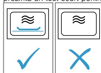
Prepararea multiplă, succesivă de popcorn la microunde la o treaptă de putere prea mare a microundelor poate determina deteriorarea interiorului cuporului.
