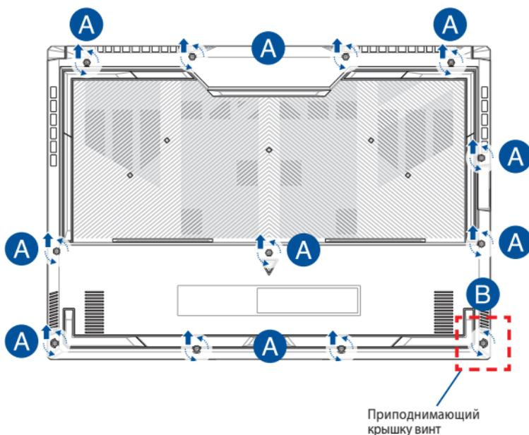
Для закрытия крышки отсека:
